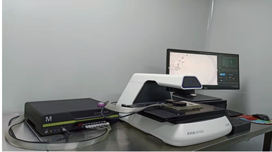
注:微流控系统构成(包括)一个计算机软件接口、一个气动流量控制器,以及密封在微流控板上的透明歧管
