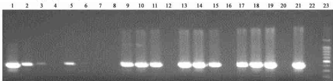
1 起始菌液; 2 起始菌液 10 倍稀释; 3 起始菌液 100 倍稀释; 4 起始菌液 1 000 倍稀释; 5 10^2 CFU/mL 增菌 4 h; 6 10 CFU/mL 增菌 4 h; 7 1 CFU/mL 增菌 4 h; 8 增菌液空白对照; 9 10^2 CFU/mL 增菌 6 h; 10 10 CFU/mL 增菌 6 h; 11 1 CFU/mL 增菌 6 h; 12 增菌液空白对照; 13 10^2 CFU/mL 增菌 8 h; 14 10 CFU/mL 增菌 8 h; 15 1 CFU/mL 增菌 8 h; 16 增菌液空白对照; 17 10^2 CFU/mL 增菌 10 h; 18 10 CFU/mL 增菌 10 h; 19 1 CFU/mL 增菌 10 h; 20 增菌液空白对照; 21 阳性对照; 22 阴性对照; 23 100 bp Marker。
