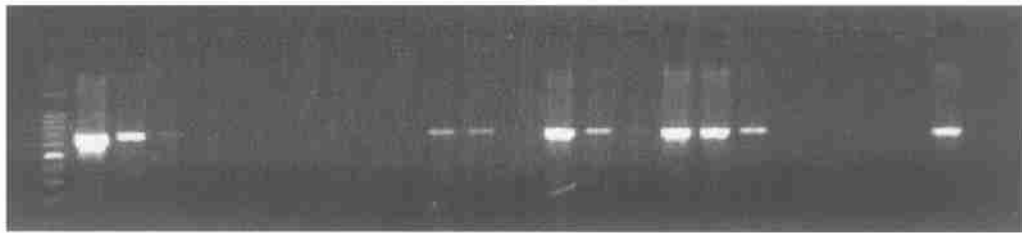
1:100 bp marker;2:过夜培养起始菌 DNA;3:起始菌 10 倍稀释;4:起始菌 10^{-2} 倍稀释;5: 3.9 \times 10^2 cfu/mL,振荡培养 8 h;6:39 fu/mL,振荡培养 8 h;7:3.9 cfu/mL,振荡培养 8 h;8: 3.9 \times 10^2 cfu/mL,振荡培养 18 h;9:39 cfu/mL,振荡培养 18 h;10:3.9 cfu/mL,振荡培养 18 h;11: 3.9 \times 10^2 cfu/mL,振荡培养 20 h;12:39 cfu/mL,振荡培养 20 h;13:3.9 cfu/mL,振荡培养 20 h;14: 3.9 \times 10^2 cfu/mL,振荡培养 22 h;15:39 cfu/mL,振荡培养 22 h;16:3.9 cfu/mL,振荡培养 22 h;17: 3.9 \times 10^2 cfu/mL,振荡培养 24 h;18:39 cfu/mL,振荡培养 24 h;19:3.9 cfu/mL,振荡培养 24 h;20:空白对照,振荡培养 8 h;21:空白对照,振荡培养 12 h;22:空白对照,振荡培养 18 h;23:空白对照,振荡培养 24 h;24:阳性对照;25:阴性
