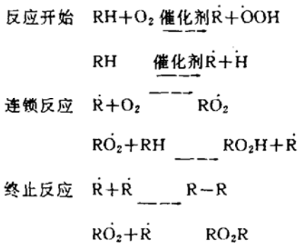
图2 油脂自动氧化时自由基反应机理示意图
